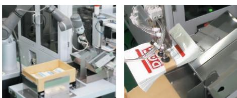
集積・帯掛け後の製品をロボットアームで箱詰め。
